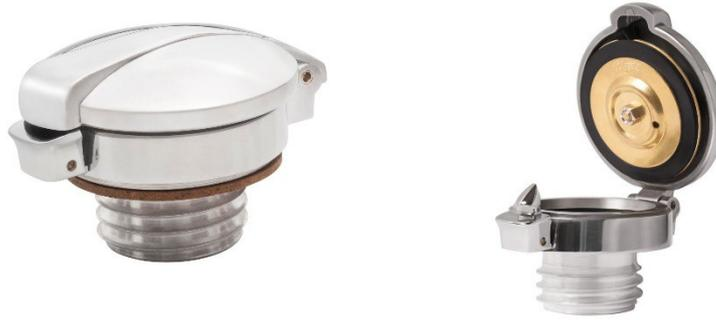
1. Legen Sie die Korkdichtung (D) unter das Adapterstück (A). Der dünnere O-Ring (E) verläuft zwischen dem Ringadapter (B) und dem Tankdeckel(C). Schrauben Sie das Adapterstück und den Deckel zusammen.
