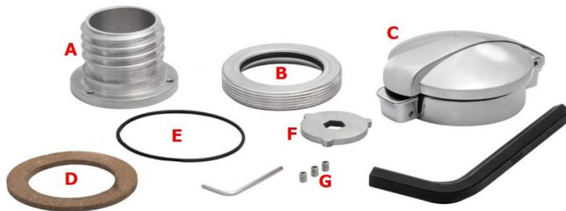
2. Schrauben Sie den Tankdeckel mit Adapterstück in den Tank und ziehen Sie die Schrauben (G) leicht an; an diesem Punkt wird die Kappe womöglich im falschen Winkel stehen. Die Kappe sollte in der Linie mit dem Tank stehen, wobei der Öffnungsverschluß zum Fahrer zeigen sollte.
